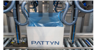
Die Seitenfalteinrichtung faltet den Beutel
