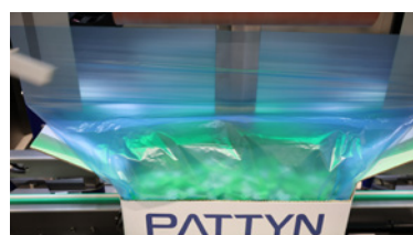
Sellado al vacío e inyección de gas
