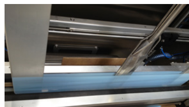
Pinza para desplegar la bolsa con control de despliegue integrado
