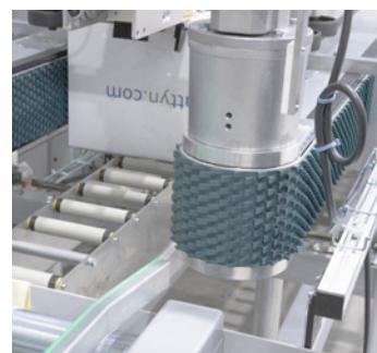
Cintas laterales robustas, accionadas por 2 motores
