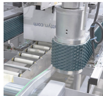
Robuste Seitenbänder, durch 2 Motoren angetrieben
