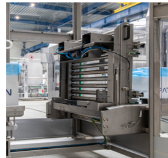
Kippbares Einlaufband für einfache Reinigung
