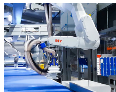
Robot installé au plafond
