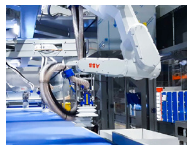
An der Decke montierter Roboter
